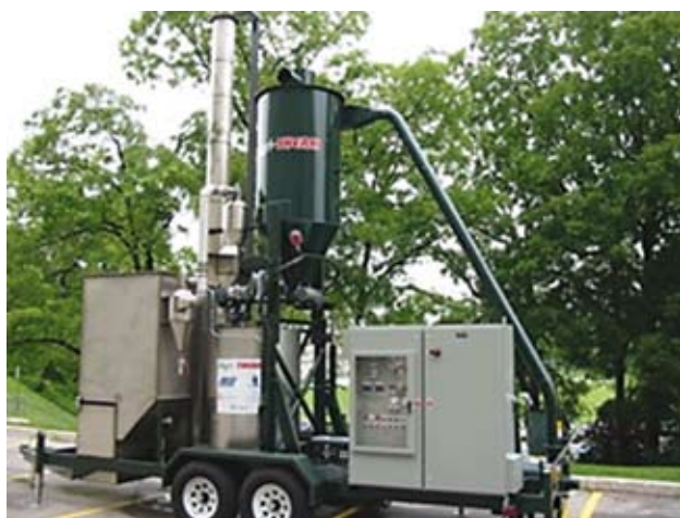
Figur 20: Eksempel på et mobilt pyrolyseringsanlegg (Agri-Therm, 2009)
