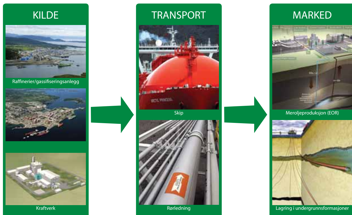
Figur 9: CO 2 -håndtering består av fangst av CO 2 fra store punktutslippskilder som kraftverk og industri, transport av CO 2 i rør eller skip, og plassering av CO 2 i trygge formasjoner under jorda. I noen tilfeller brukes også CO 2 for å øke utvinningsgraden i oljefelt (Grafikk: ZERO).
