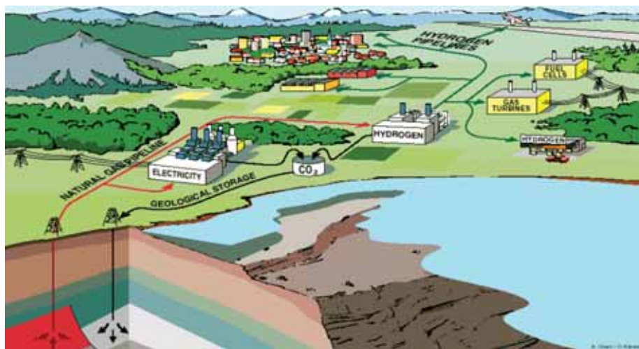
Figur 1. Produksjon og bruk av elektrisitet og hydrogen med CO 2 -fangst og lagring. (Grafikk: StatoilHydro).
