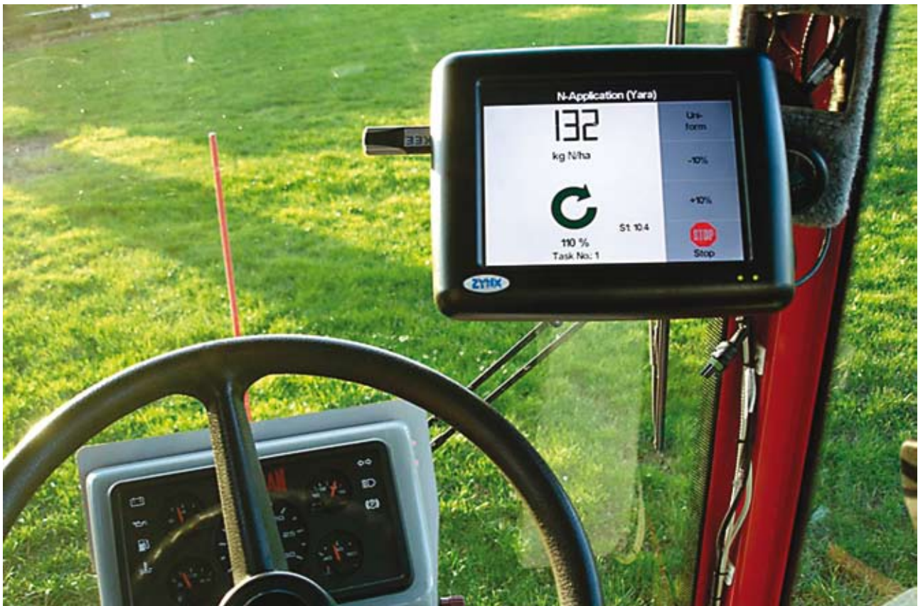
Yara N-Sensor™ fordeler gjødsla etter varierende behov på feltet under kjøring (foto: Yara)
